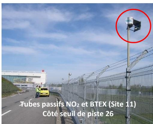
**Figure 1** : Système tube passif (support, boîtes et tubes).
