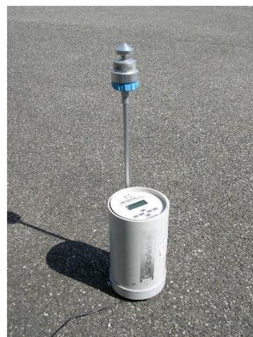
Figure 2 : Préleveur MicroVol.
