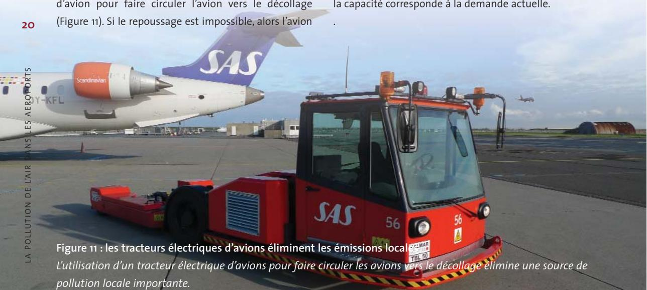
Figure 11 : les tracteurs électriques d'avions éliminent les émissions locales. L'utilisation d'un tracteur électrique d'avions pour faire circuler les avions vers le décollage élimine une source de pollution locale importante.
