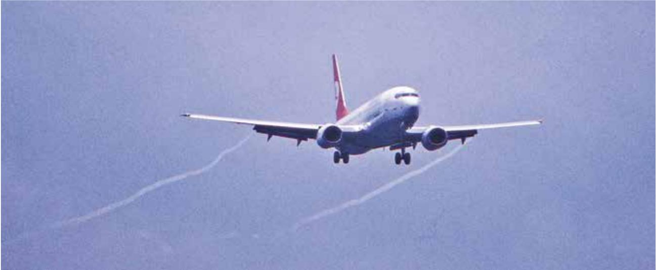
Traînées de condensation de vapeur d'eau en phase d'atterrissage
