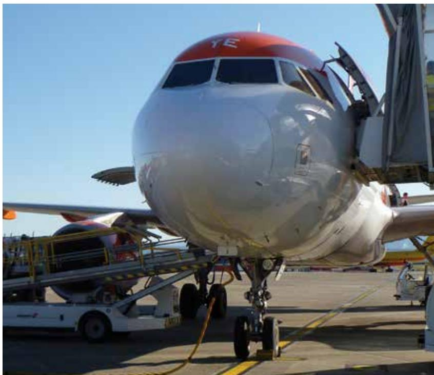
Si l'expression « off-block » vient de l'enlèvement des cales de roues ou « block » avant le décollage de l'avion, le terme « on-block » correspond à la mise en place de ces cales après l'atterrissage.
