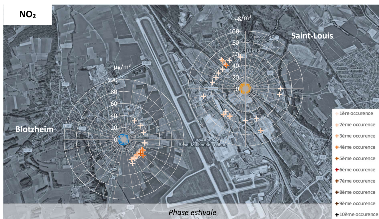
Figure 75 : Rose de pollution des 20 mesures ¼ horaires les plus élevées en dioxyde d'azote (NO 2 ) relevées au cours de la campagne, sur les sites de Blotzheim (19LM) et Saint-Louis (17LM).
