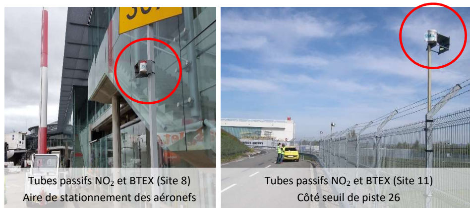
Figure 1 : Système de tubes passifs (support, boîtes et tubes).
