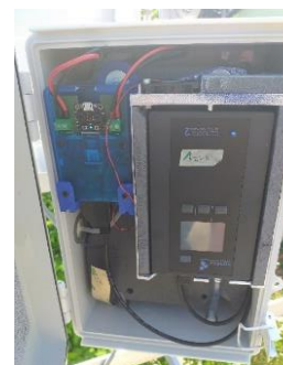
Figure 2 : Partector 2 dans son caisson étanche
