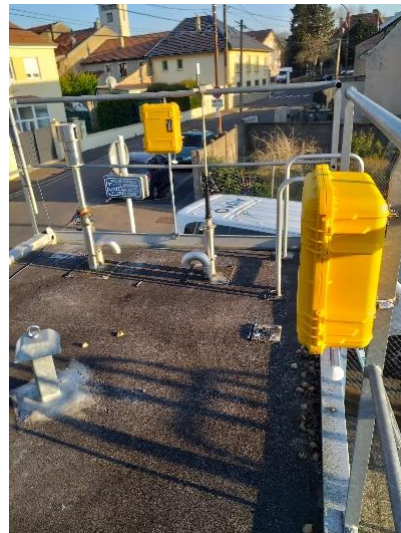
Figure 6 : Partector 2 dans leur boîtier jaune sur le toit de la station
