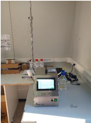
Figure 5 : Condensation Particle Counter (CPC) de référence à l'intérieur de la station
